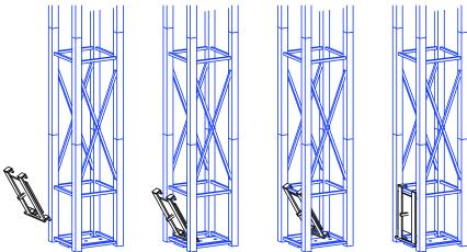
UPPER HORIZONTAL TRUSS MOUNTS FLUSH WITH TOP OF UPRIGHT
