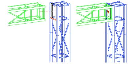
ATTACH HORIZONTAL TRUSS SO THAT THE STUD (ON THE BRACKET) PASSES THROUGH THE CENTER HOLE OF THE ENDPLATE AS SHOWN AND LOCK PARTS INTO PLACE USING THE WINGNUT AS SHOWN. ENSURE THAT THE ALIGNMENT ROD (ORANGE) ON THE BRACKET IS SEATED BETWEEN THE TRUSS CORDS
